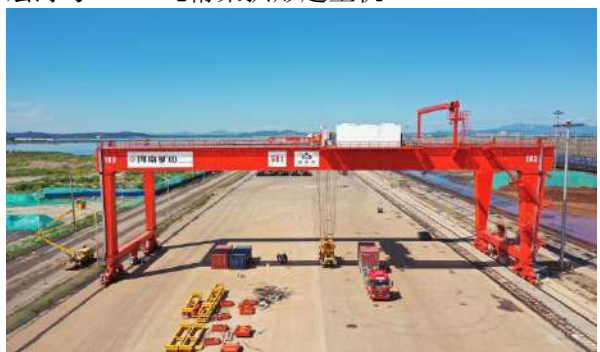
锦州港50吨集装箱门吊
