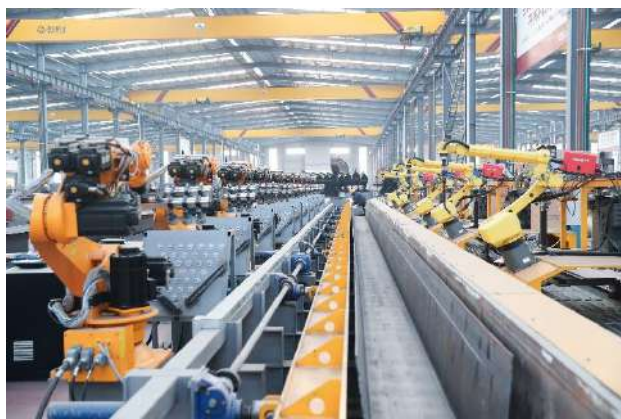
单梁筋板组装焊接工作站
