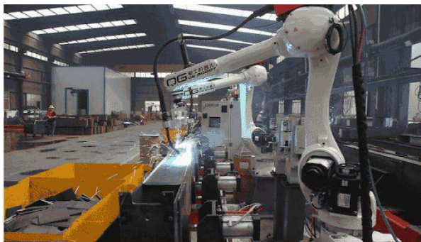
单梁端梁机器人焊接流水线
