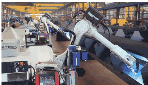
单梁主梁内缝机器人焊接流水线
