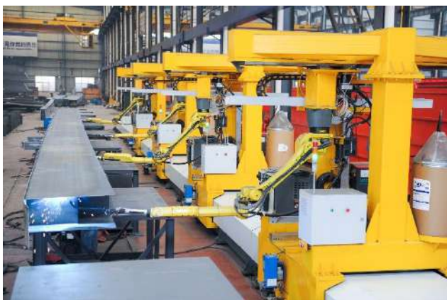
全自动双梁主梁内缝机器人焊接工作站
