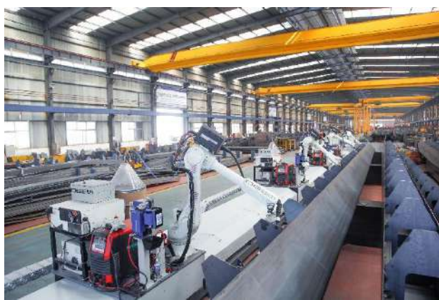
单梁主梁内缝机器人焊接流水线
